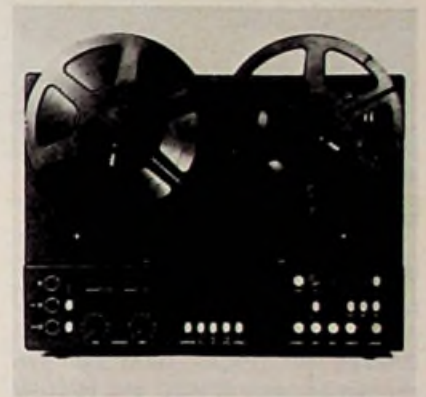
Bild 1. Hi-Fi-Tonbandgerät „TG 1020“ mit schaltbarem Computer für automatisch gesteuerte Ein- und Ausblendungen
