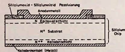
Bild 5. Schematischer Schnitt durch einen Schottky-Gleichrichter
