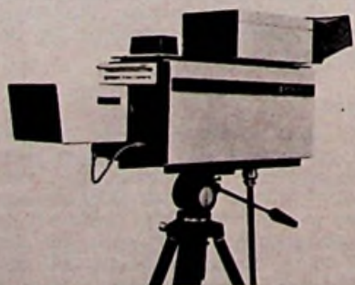
Farbfernsehkamera „FP-1212“ von Hitachi mit 1"-Plumbicon-Aufnahmeröhren
