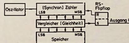
Bild 3. Umformung der Digital-Information in ein Tastzeitverhältnis nach dem „stochastischen“ Verfahren
